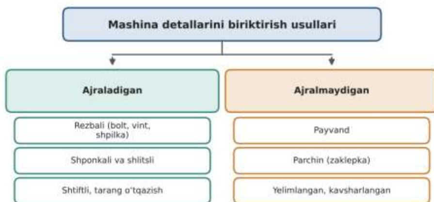
15-rasm. Mashina detallarini biriktirish usullari
