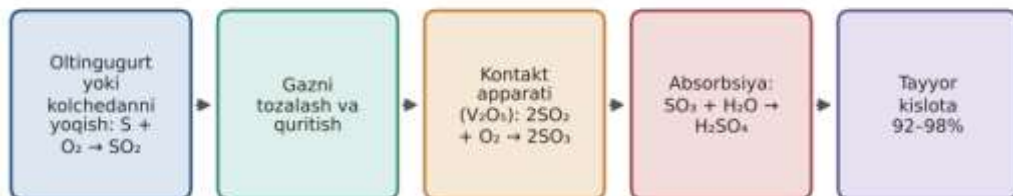
16-rasm. Sulfat kislota kontakt usulida ishlab chiqarish sxemasi
