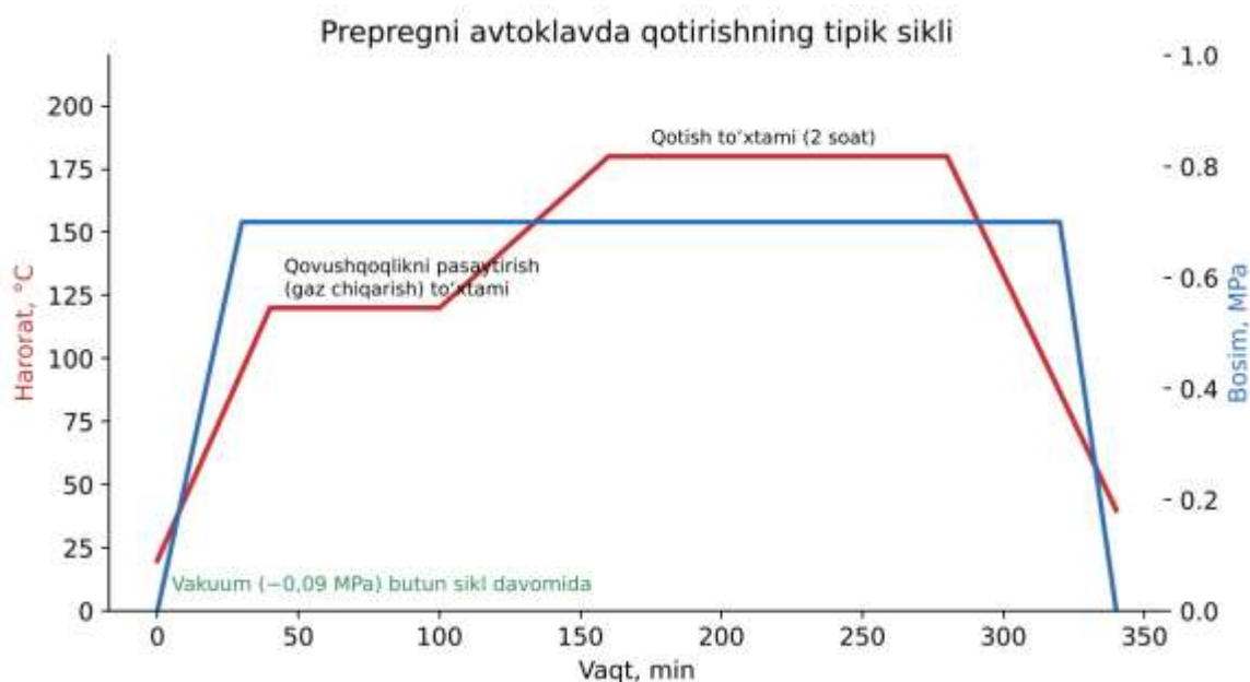
8-rasm. Prepregni avtoklavda qotirishning tipik sikli
